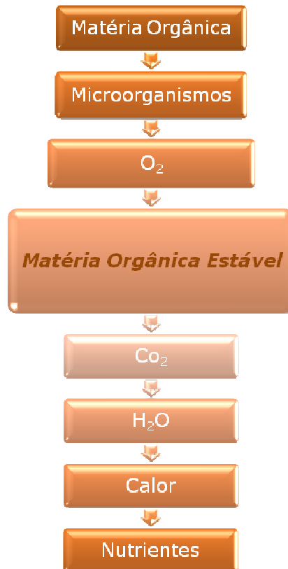
Fluxograma 4 - Processo simplificado de compostagem (Fonte: Manual prático para a Compostagem de Biossólidos – UEL).
