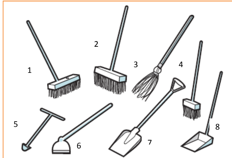
Figura 66 - 1 - Vassoura moderna, 2 - vassourão, 3 - vassoura de bruxa, 4 - vassoura pequena, 5 - chave para ralo, 6 - enxada para limpeza de ralo, 7 - pá quadrada e 8 - pá especial para varrição.
